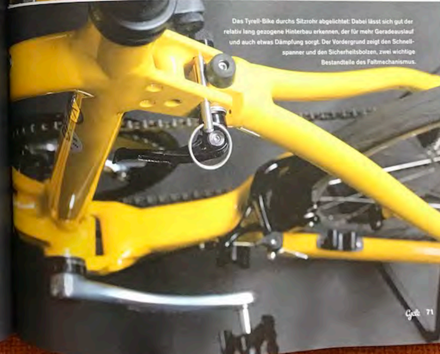
Spezieller Blickwinkel durch die Speichen auf die Kreuzrahmen-Konstruktion mit den beiden doppelten Querstreben: Sie dienen in erster Linie der Stabilität des Faltrads. Gleichzeitig tragen sie ihren Teil zum filigranen Designaufbau des japanischen Bikes bei.
